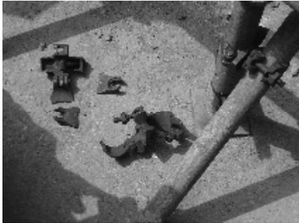
扣件松脱、滑移、断裂
