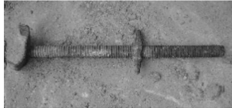
可调托撑螺杆偏细、托板变形
