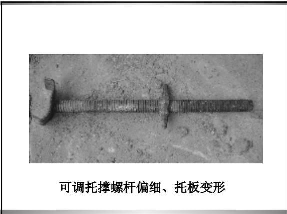
可调托撑螺杆偏细、托板变形
